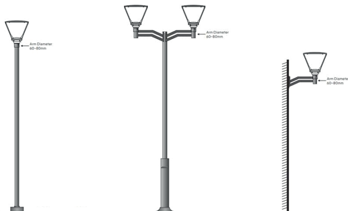
Receptáculo para inserción de tubo ajustable entre 60 – 80 mm.
